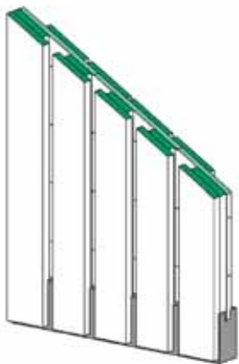
U*psi T (Tragender Dämmständer für den Holzrahmenbau)
